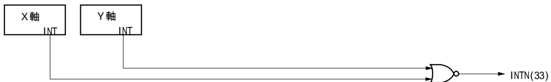
図2.40 IC 内の割り込み信号経路
